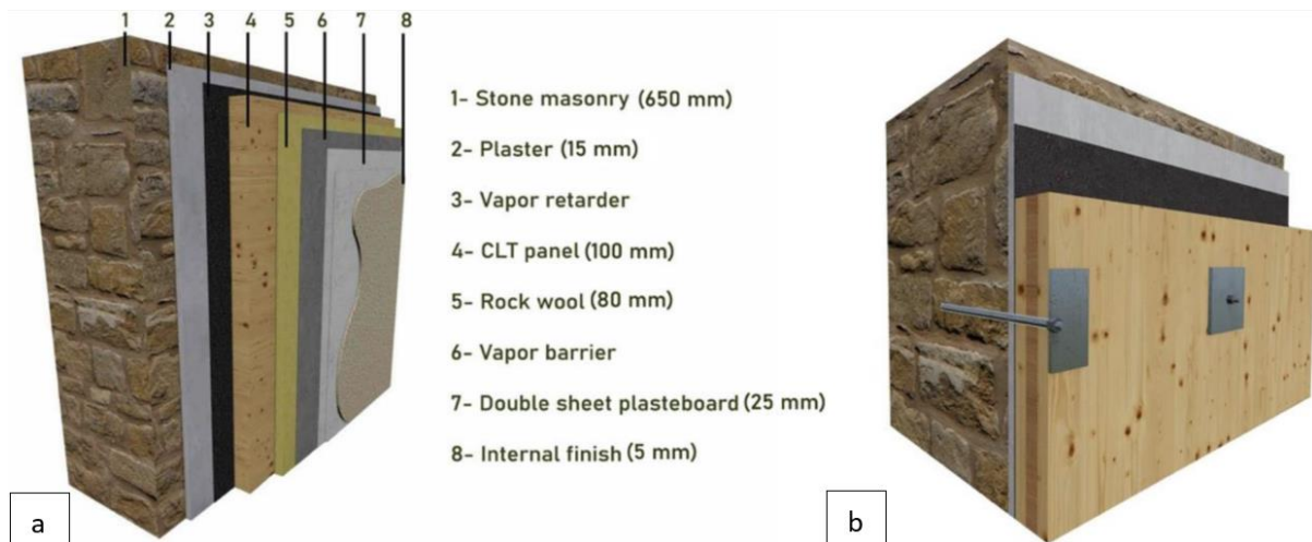
Σχήμα 7: Παράδειγματα (a) Στρωμάτων εφαρμογής αναβάθμισης CLT (b) Συνδέσεις αυτών [17]
