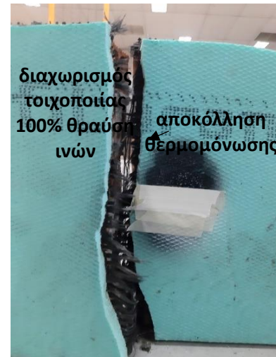
Σχήμα 6.4 Το δοκίμιο M_2L_iX το οποίο υποβάλλεται σε ανακυκλιζόμενη εντός επιπέδου κάμψη τριών σημείων και οι αστοχίες του
