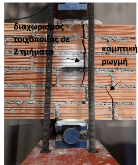
Σχήμα 6.2 Το δοκίμιο ελέγχου C το οποίο υποβάλλεται σε ανακυκλιζόμενη εντός επιπέδου κάμψη τριών σημείων και οι αστοχίες του
