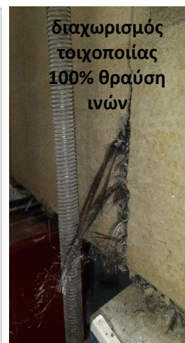
Σχήμα 6.3 Το δοκίμιο M_2L_iR_f το οποίο υποβάλλεται σε ανακυκλιζόμενη εντός επιπέδου κάμψη τριών σημείων και οι αστοχίες του
