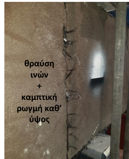
Σχήμα 6.2 Το δοκίμιο M_2L_f το οποίο υποβάλλεται σε ανακυκλιζόμενη εντός επιπέδου κάμψη τριών σημείων και οι αστοχίες του
