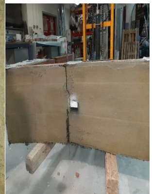
Σχήμα 6.3 Το δοκίμιο M_2L_iR_f το οποίο υποβάλλεται σε ανακυκλιζόμενη εντός επιπέδου κάμψη τριών σημείων και οι αστοχίες του
