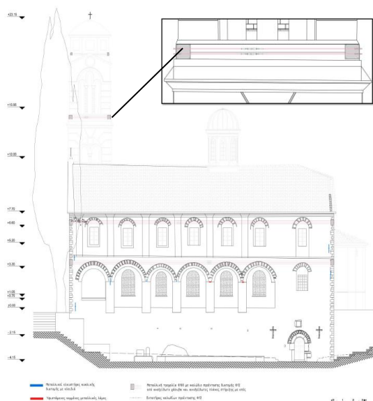
Σχήμα 41: Τοποθέτηση ανοξειδωτων καλωδίων προέντασης Φ12 με τροχαλία
