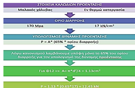
Σχήμα 21: Υπολογισμός δύναμης προέντασης καλωδίων
