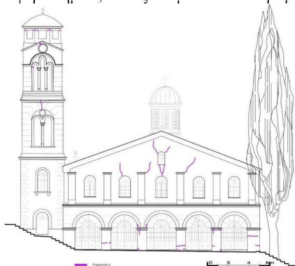
Σχήμα 27: Παθολογία δυτικής όψης
