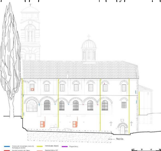
Σχήμα 28: Παθολογία νότιας όψης
