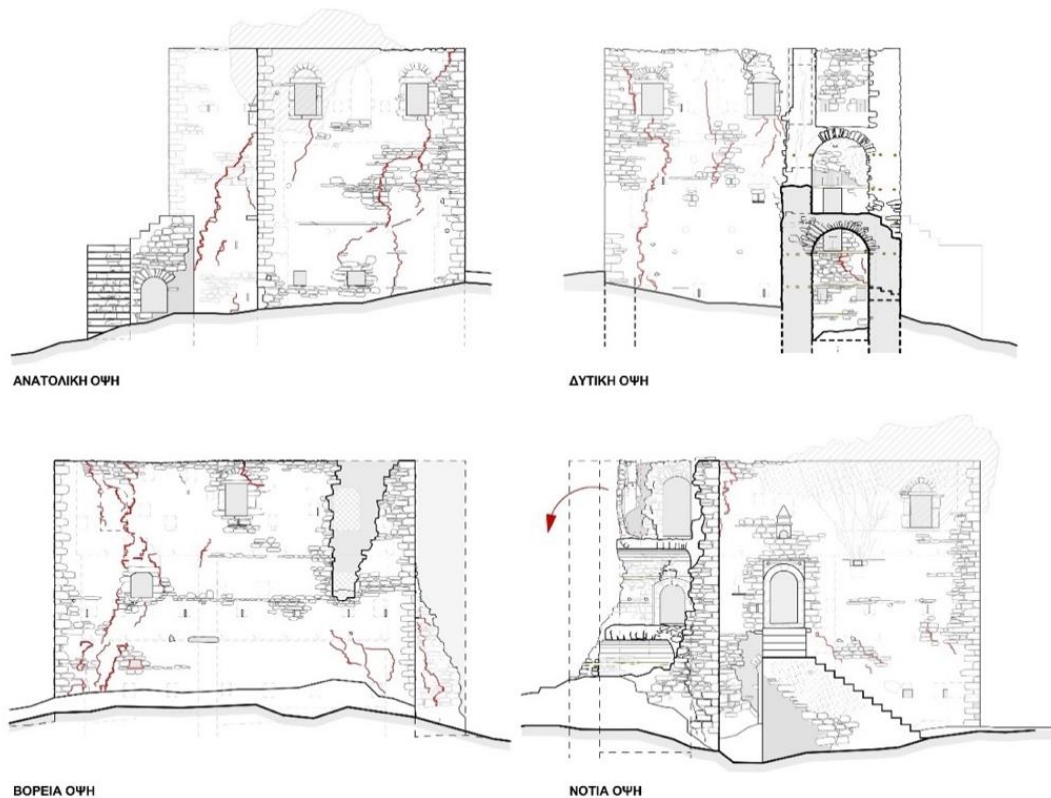
Σχήμα 9: Ποιοτική ερμηνεία της παθολογίας του κτιρίου - επισήμανση των ρωγμών με κόκκινο χρώμα στις όψεις του κτιρίου.
