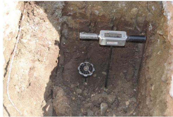
ΦΩΤ.03. Επιτόπου δοκιμές στο εσωτερικό του 1 ου φρέατος με πενετρόμετρο χειρός για τον προσδιορισμό του Q_c και δοκιμή με Vane Tester για τον προσδιορισμό των τιμών C_u .
