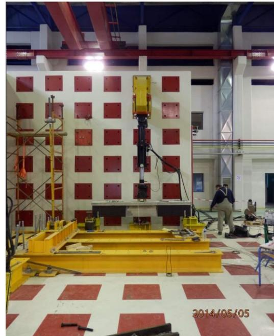
“Πειραματική διερεύνηση της ικανότητας σε **κόπωση** δοκού ωπλισμένου σκυροδέματος ενισχυμένης έναντι **διάτμησης** με υφάσματα ινωπλισμένου πολυμερούς (CFRP)”
