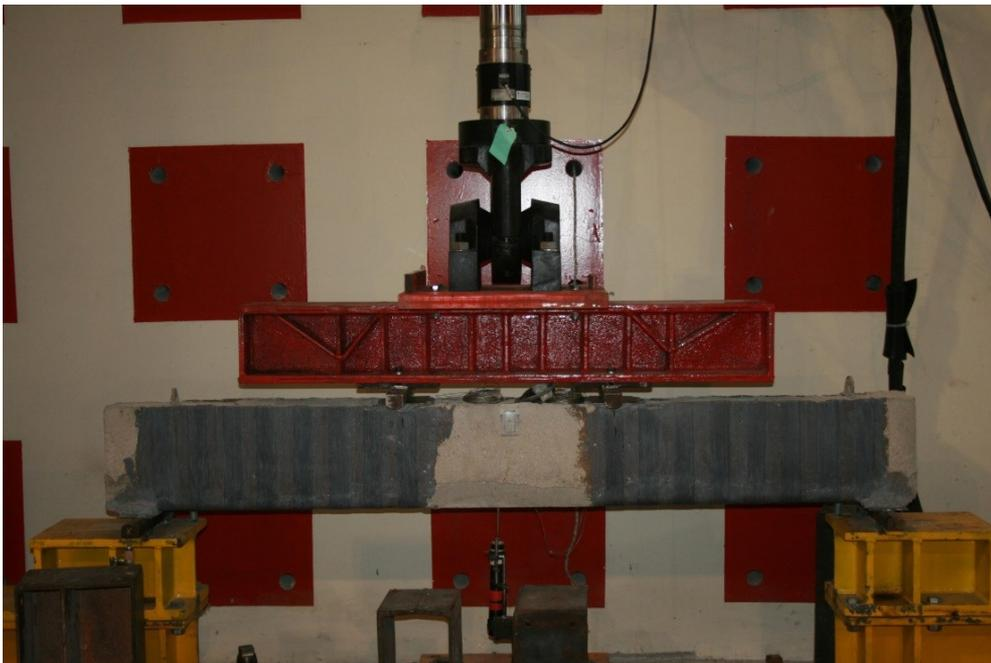
Στο εργαστήριο Ωπλισμένου Σκυροδέματος του Δημοκρίτειου Πανεπιστημίου Ξάνθης πραγματοποιείται πειραματική διερεύνηση, στα πλαίσια διδακτορικής διατριβής της συμπεριφοράς στοιχείων δοκών από υπηλαμένο σκυρόδεμα που έχουν υποστεί διάβρωση του χαλύβδινου οπλισμού. Δύο δοκοί πρόκειται να επισκευαστούν και να ενισχυθούν καμπτικά και διατμητικά με σύνθετα υλικά FRP.
