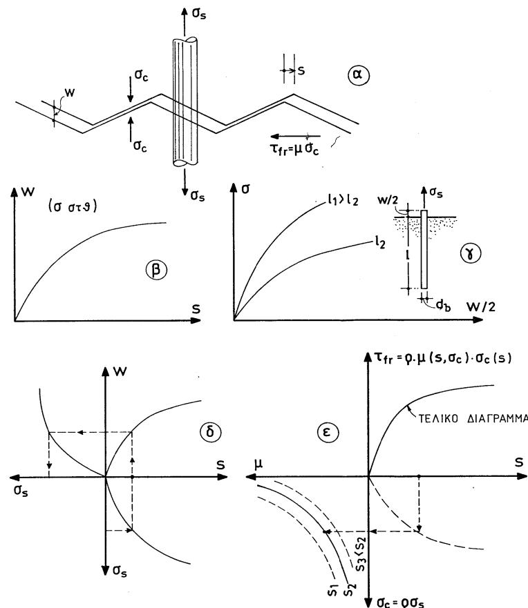
Σχ. Σ.6.4: Η λειτουργία του μηχανισμού σφιγκτήρα: (α) σχηματική παράσταση τραχείας ρωγμής, (β) μεταβολή του ανοίγματος της ρωγμής συναρτήσει της σχετικής ολισθήσεως, (γ) εφελκυστική τάση στην ράβδο οπλισμού συναρτήσει του ανοίγματος της ρωγμής και του διατιθέμενου μήκους αγκυρώσεως, (δ) υπολογισμός της τάσεως του οπλισμού συναρτήσει της επιβαλλόμενης ολισθήσεως, (ε) υπολογισμός
