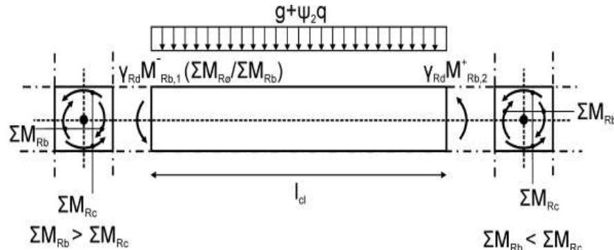
Σχ. Σ.9.2 Ενδεικτικό παράδειγμα καμπτικών αντιστάσεων στα άκρα δοκών για ικανοτικόν υπολογισμόν τέμνουσας δύναμης
