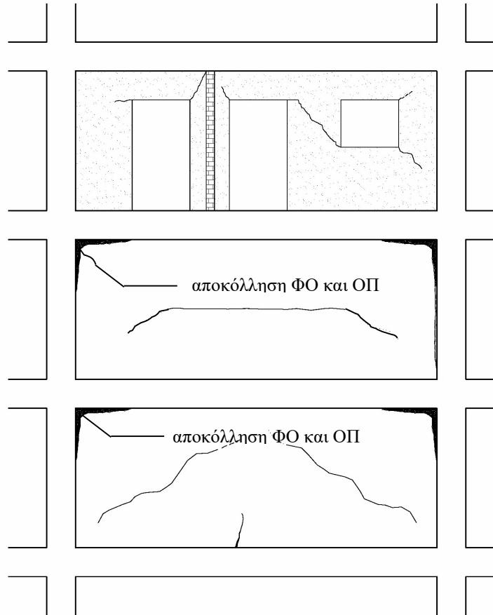
Σ2.1 : Χαρακτηριστικές ελαφρές (έως μέτριες) βλάβες τοιχοπληρώσεων, με ρωγμές εύρους < 2÷3mm
