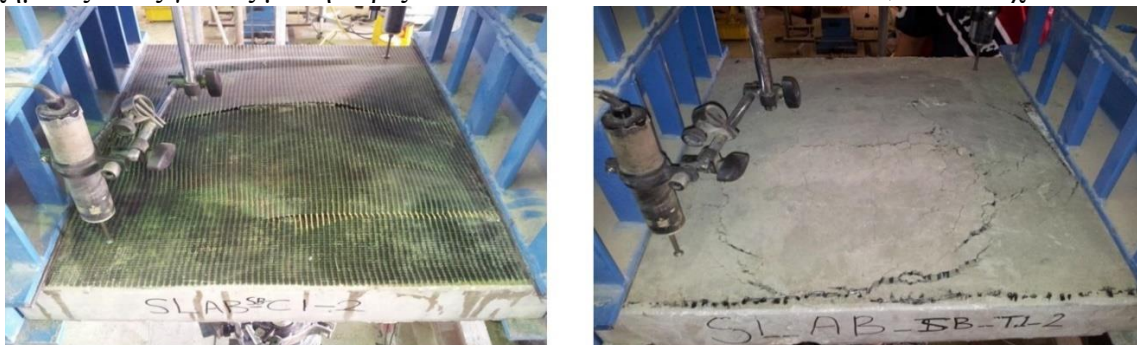
Σχήμα 4. Μορφές αστοχίας πλακών με : CFRP (αριστερά) , TRM (δεξιά) [1]
