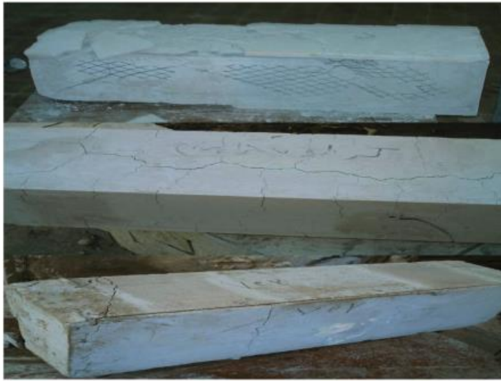
Σχήμα 7: Κατάσταση δοκών μετά τη δοκιμή πυρός. α)Χαλαζίας, β)Θραύσματα πυρότουβλου/τσ.αλουμίνας, γ)Βερμικουλίτης/OPC [14]
