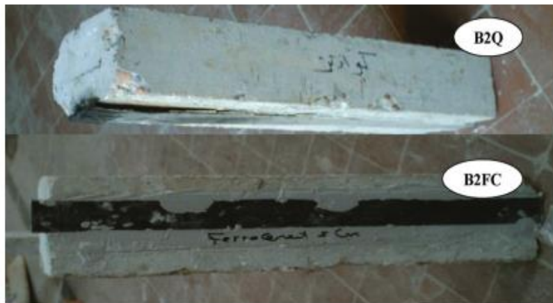
Σχήμα 8: Κατάσταση CFRP μετά τη δοκιμή πυρός. α)Χαλαζίας, β)Φεροτσιμέντο/OPC [14]
