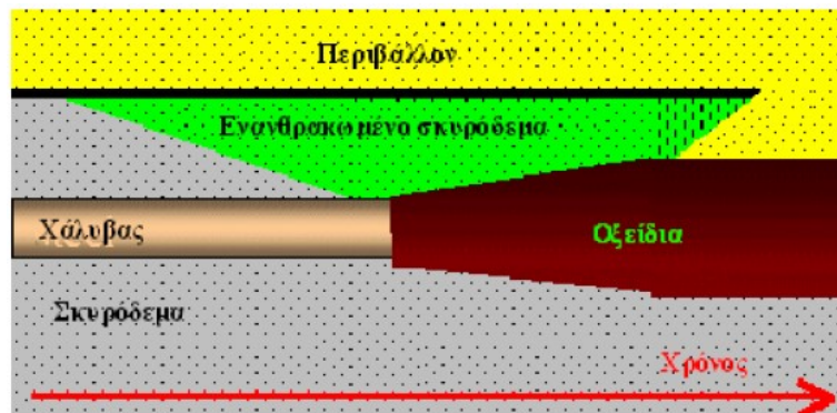
Εικόνα 3.2: Απεικόνιση της Διαδικασίας Σταδιακής Ενανθράκωσης και Εκτίναξης του Σκυροδέματος[3]
