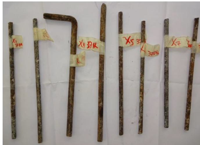
Εικόνα 2.1: Δοκίμια Οπλισμού Γέφυρας.
