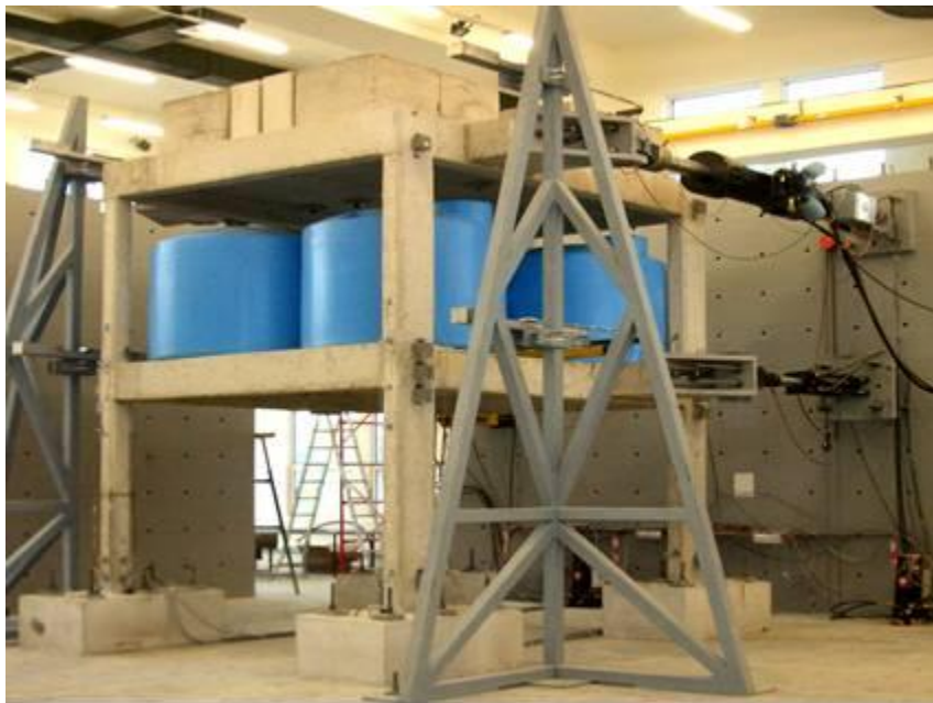
Δοκιμή 0.3g πριν την ενίσχυση
