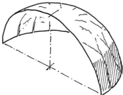
Σύνηθες σύστημα ρωγμών σε τεταρτοσφαιρικό θόλο
