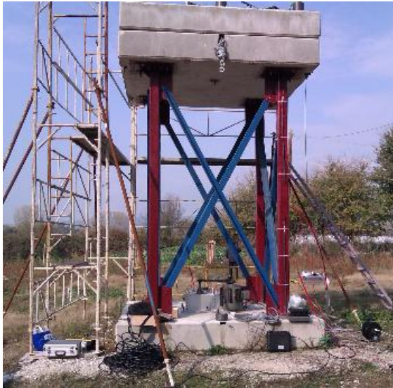
Ηλεκτρομηχανικός Διεγέρτης Κατασκευών ANCO
