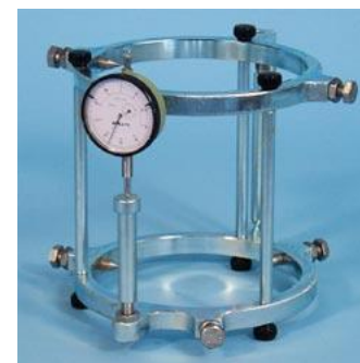
Μέτρο ελαστικότητας Κυλινδρικών Δοκιμίων
