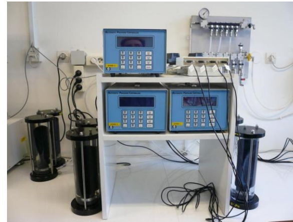
Αυτόματος έλεγχος πίεσης σε τριαξονικές δοκιμές εδαφών
