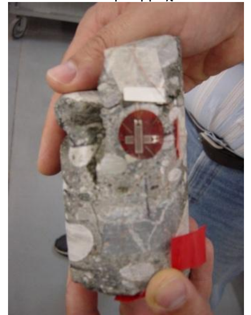
Μέτρηση λόγου Poisson σε δοκίμια βράχου
