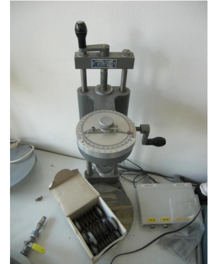
Χειροκίνητη συσκευή διάτμησης πτερυγίου
