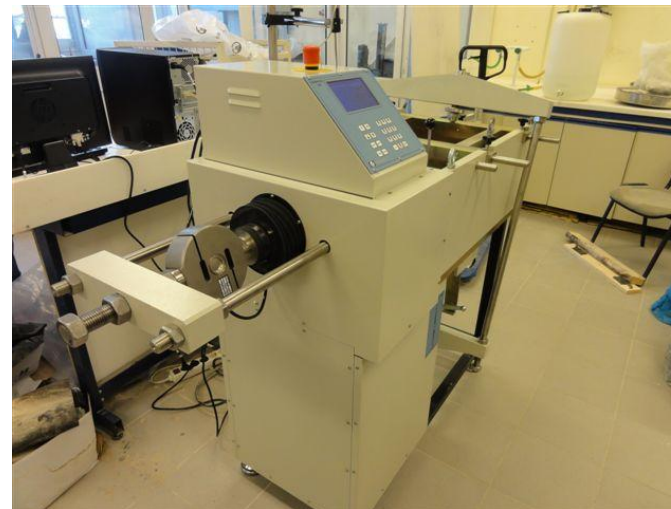
Μηχανή δοκιμής σε διάτμηση αδρανών & Γεωυφασμάτων Δοκίμιο 40X40cm
