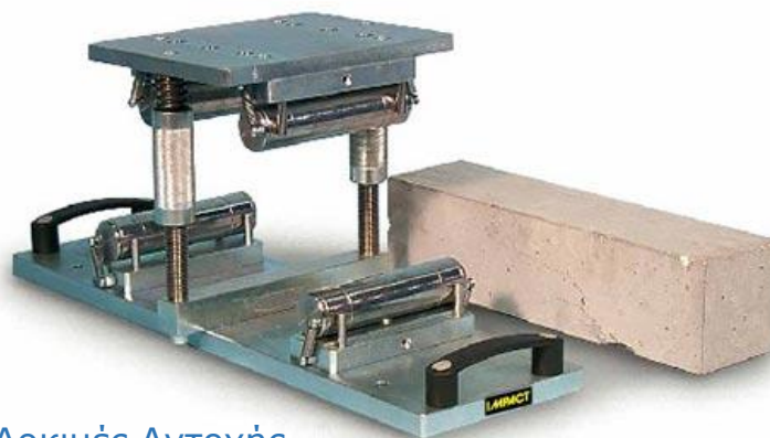
Δοκιμές Αντοχής Δοκών σε κάμψη
