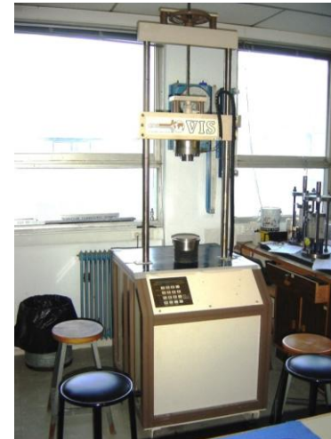
ΑΠΘ, Τεχν. Γεωλογίας, Βραχομηχανική Μηχανή άπειρης ακαμψίας
