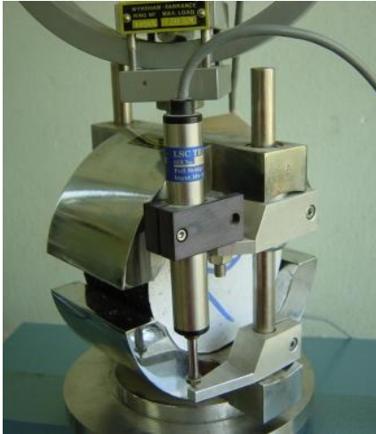
Κυψέλη θραύσης σε αυτόματη δοκιμή Marshall
