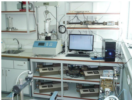
Διάταξη αυτοματοποιημένης τριαξονικής δοκιμής
