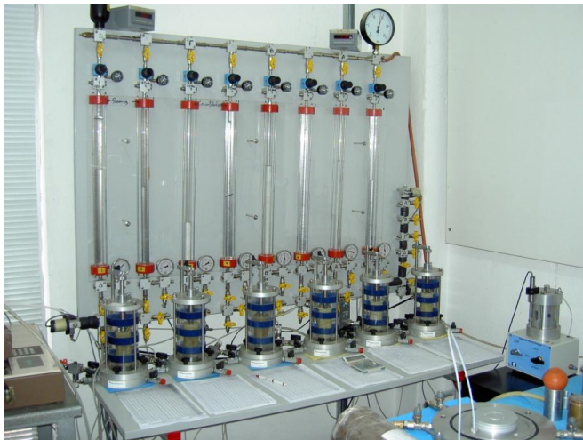
Πίνακας ελέγχου πιέσεων & κορεσμού 3αξονικών δοκιμών
