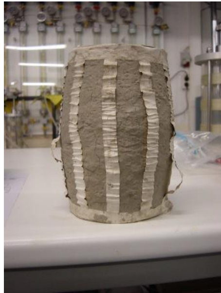
Εδαφικό δοκίμιο μετά τη θραύση σε 3αξονική δοκιμή
