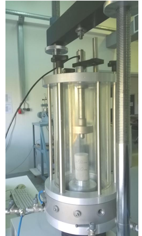
Κυψέλη Τριαξονικής Δοκιμής με δοκίμιο
