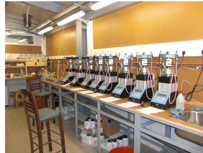
Σειρά Αυτομάτων συμπιεσομέτρων εδαφικών δοκιμών
