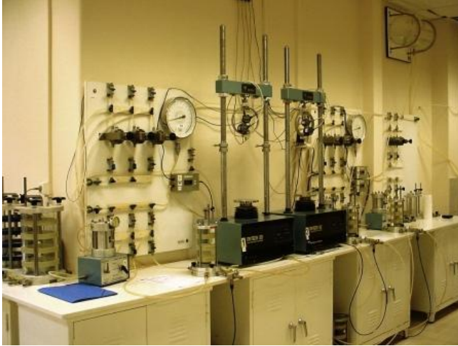
Διπλή διάταξη ταυτόχρονης διεξαγωγής αυτοματοποιημ ένων τριαξονικών δοκιμών
