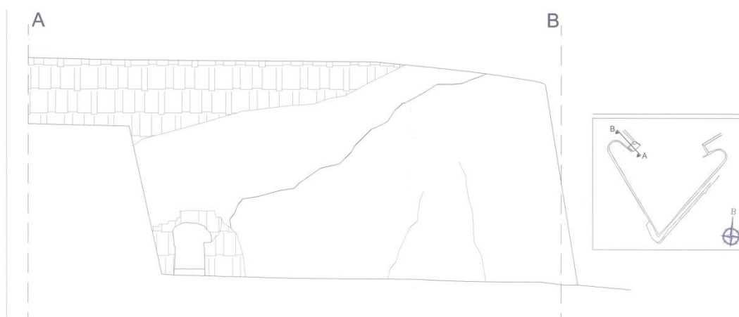
Εικόνα 30. Παθολογία δυτικού ορεκιόνε προμαχώνα Μαρτινέγκο. Σχέδιο από την Μελέτη Στερέωσης αποκατάστασης & στατικής επάρκειας Ενετικών Τειχών στον Προμαχώνα Μαρτινέγκο. [4]
