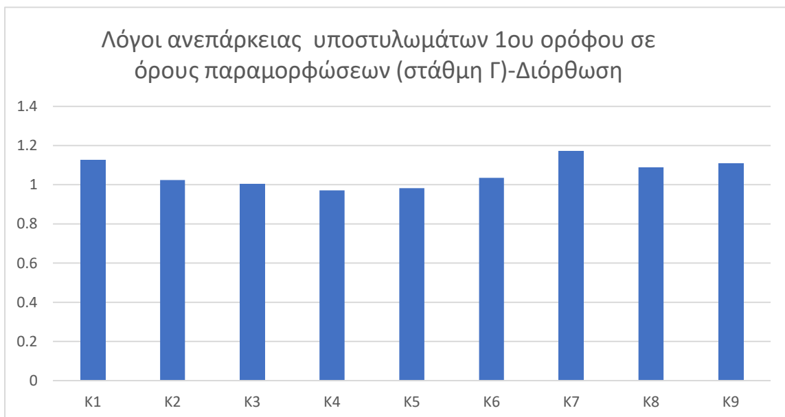
Σχήμα 3. Δείκτες ανεπάρκειας σε όρους παραμορφώσεων (1 ος όροφος)-στάθμη Γ μετά την διόρθωση της αρχικής απόκλισης του υποστυλώματος Κ5.
