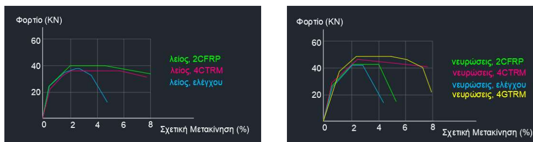
Σχήμα 31. Καμπύλες P(KN) - Σχετ. Μετακίνηση(%). : α) Για λείο ενιαίο χάλυβα, β) νευροχάλυβα(%)
