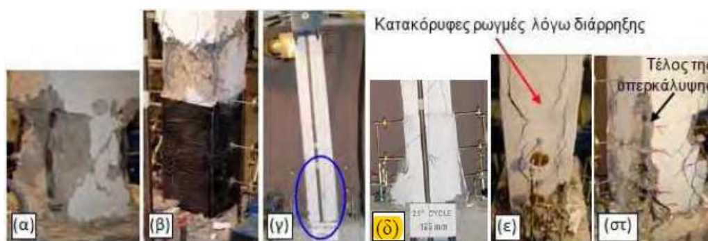
Σχήμα 33. Ενδεικτικές αστοχίες δοκιμίων [6]
