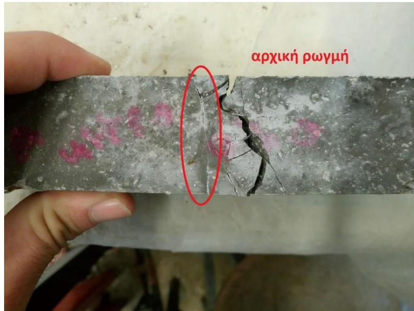
ΣΧΗΜΑ 17: ΘΕΣΕΙΣ ΑΡΧΙΚΗΣ ΡΩΓΜΗΣ ΚΑΙ ΤΕΛΙΚΗΣ ΑΣΤΟΧΙΑΣ ΔΟΚΙΜΙΟΥ ΠΟΥ ΣΥΝΤΗΡΗΘΗΚΕ ΣΤΟ ΘΑΛΑΣΣΙΝΟ ΝΕΡΟ
