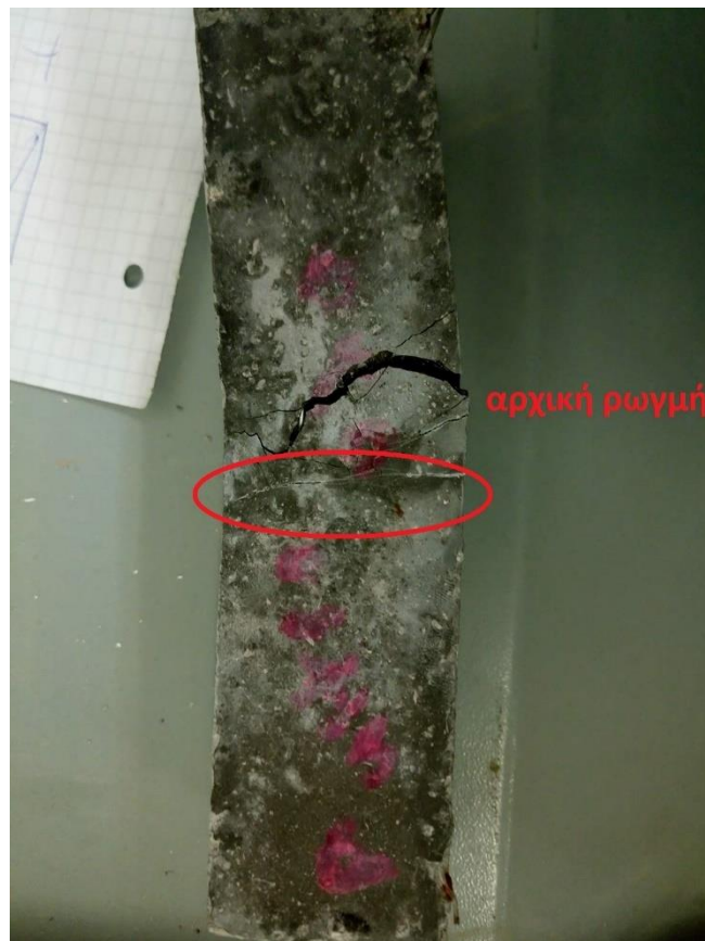
ΣΧΗΜΑ 18: ΘΕΣΕΙΣ ΑΡΧΙΚΗΣ ΡΩΓΜΗΣ ΚΑΙ ΤΕΛΙΚΗΣ ΑΣΤΟΧΙΑΣ ΔΟΚΙΜΙΟΥ ΠΟΥ ΣΥΝΤΗΡΗΘΗΚΕ ΣΤΟ ΘΑΛΑΣΣΙΝΟ ΝΕΡΟ
