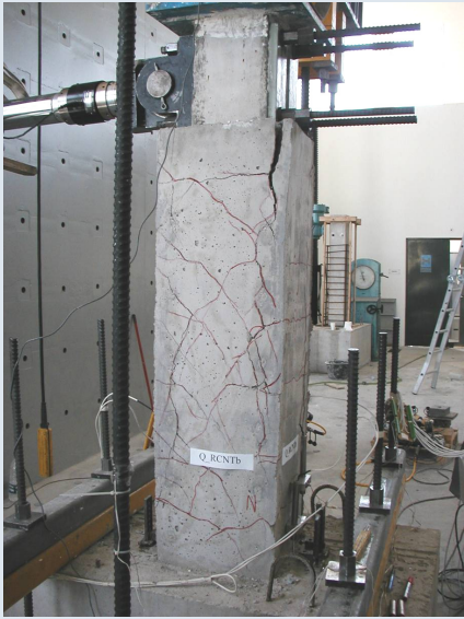
Βλάβες σε Δοκίμιο με Έγχυτο Σκυρόδεμα, Λεία Διεπιφάνεια χωρίς Διατμητικούς Συνδέσμους
