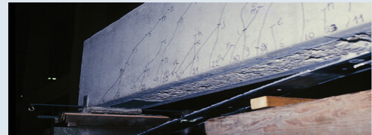
Αναλαμβάνομενη δύναμη επικολλητών φύλλων συναρτήσει του μήκους αγκύρωσης
