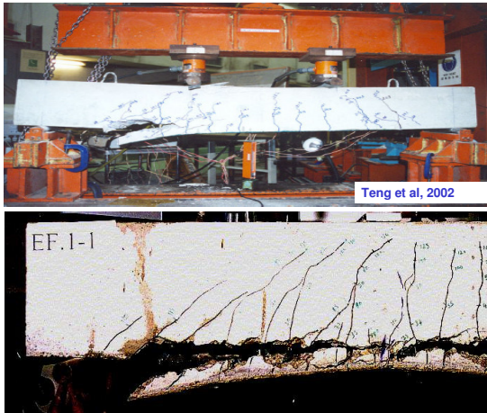
Απόσχιση επικάλυψης σκυροδέματος στο πέρας του σύνθετου υλικού
