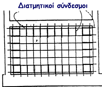
Με έγχυτο σκυρόδεμα και περιμετρική σύνδεση
