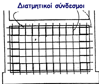
Με έγχυτο σκυρόδεμα και περιμετρική σύνδεση
