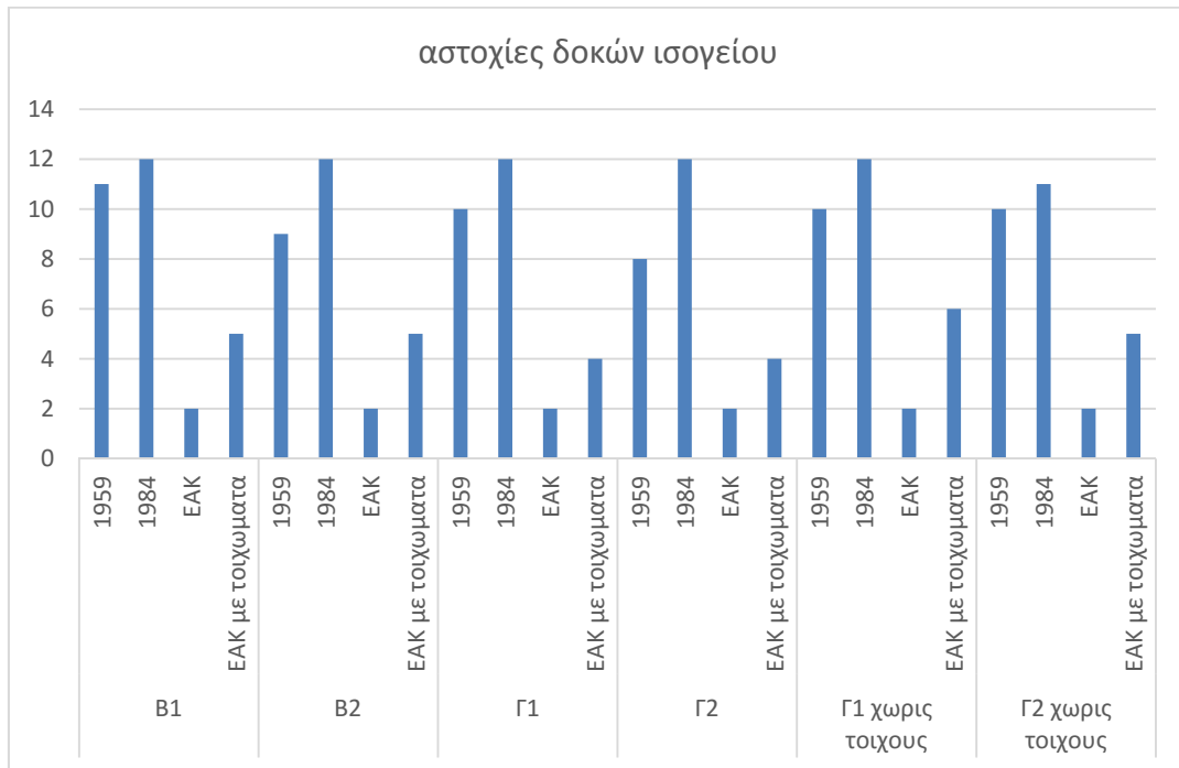
Σχήμα 4.1.3: Πλήθος δοκών του ισογείου που αστοχούν, για διάφορους στόχους επιτελεστικότητας, στα τέσσερα υπό μελέτη κτίρια
