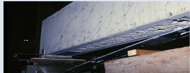
Αναλαμβανόμενη δύναμη επικολητών φύλλων συναρτήσει του μήκους αγκύρωσης
