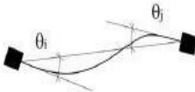
Σχήμα 10: Γωνίες στροφής χορδής σε κάθε κόμβο μέλους
