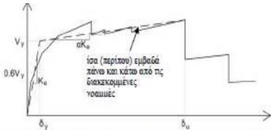
Σχήμα 3.7 Εξιδανίκευση μίας (σχηματικής) καμπύλης αντίστασης της κατασκευής με διγραμμική καμπύλη
