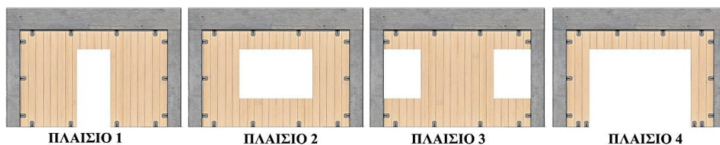
Σχήμα 8: Αντιπροσωπευτικές περιπτώσεις ανοιγμάτων που ελέγχθησαν.
