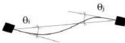
Σχήμα 5: Γωνία στροφής χορδής [3]
